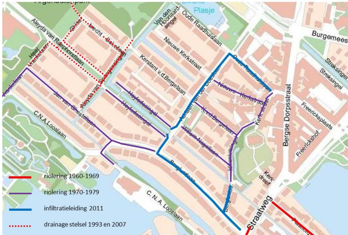
Fig. 3.3a Infiltratieleiding, drainage stelsel en mogelijk lekkende riolen
